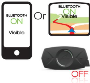
Das **SHARKTOOTH** muss ausgeschaltet sein. Schalten Sie die Bluetoothfunktion Ihres Telefons oder GPS-Geräts in einen sichtbaren Modus.
