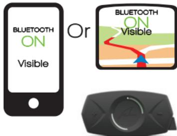
Führen Sie eine Bluetoothsuche aus und wählen Sie **SHARKTOOTH**. Geben Sie 0000 ein, falls das Telefon oder GPS-Gerät nach einem Passwort oder Pincode fragt.
