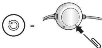
Drücken Sie 1 Sekunde lang leicht in das **Reset-Stiftloch**. Das Headset schaltet sich automatisch aus und ein Reset bei Fehlfunktion wird durchgeführt.
