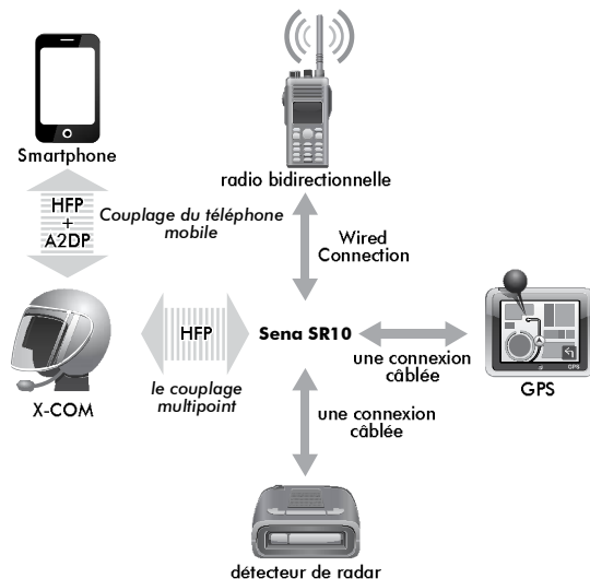
Connexion parallèle du SR10 et du téléphone mobile par couplage Bluetooth multipoint
