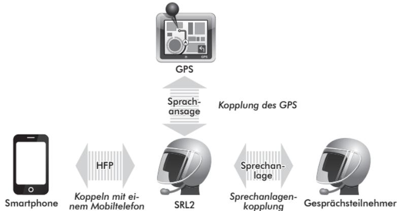
**Sprechanlage und Sprachansage des Navigationsgeräts**
